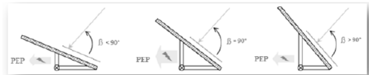
Figure (I.8) : Dépendance des performances d'un panneau PV de l'angle β[9]
