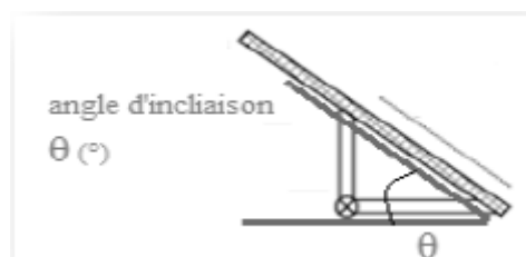
Figure (I.10) : Représentation de l'angle d'inclinaison \theta [9]
