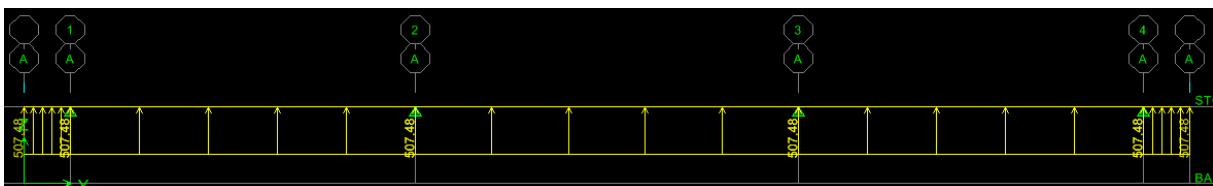
Figure VIII.17 : chargement à l'ELS pour les moments (sens transversal)
