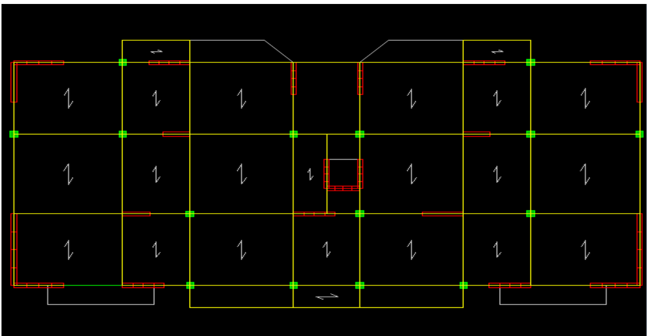
Figure IV. 2 : disposition des voiles
