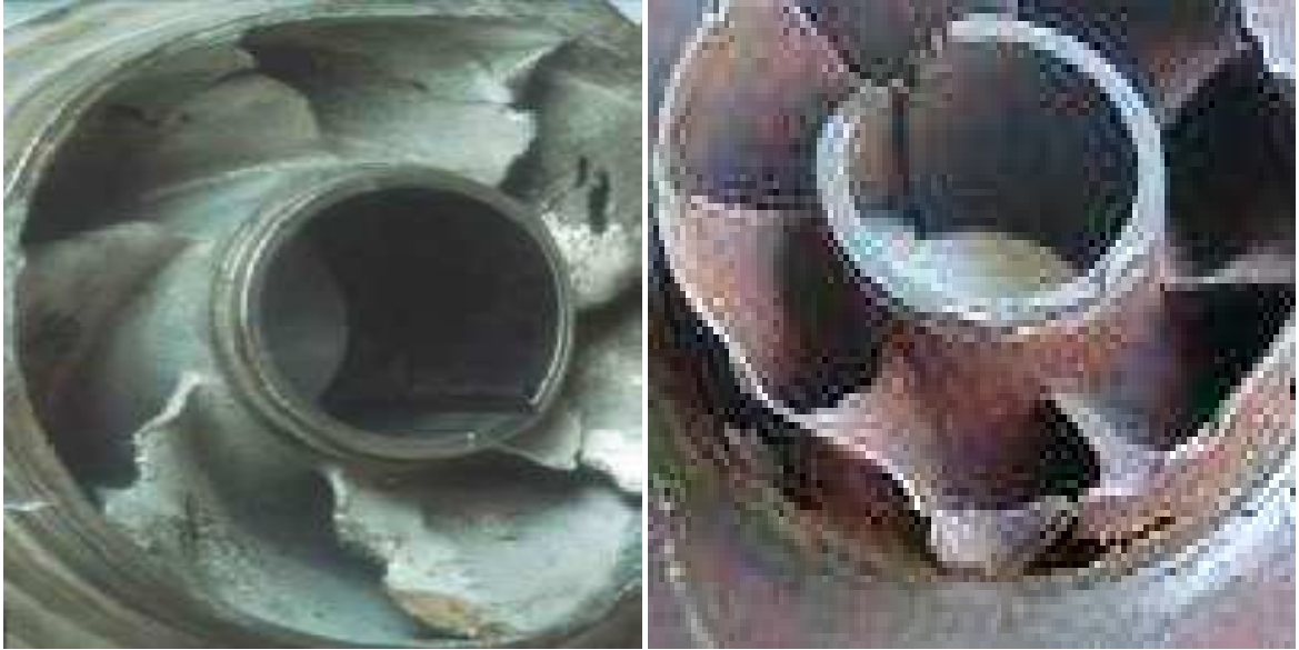
Figure. 7.4 : Photos illustrant les dommages causer par le phénomène de cavitation sur les Aubes d'une pompe centrifuge
