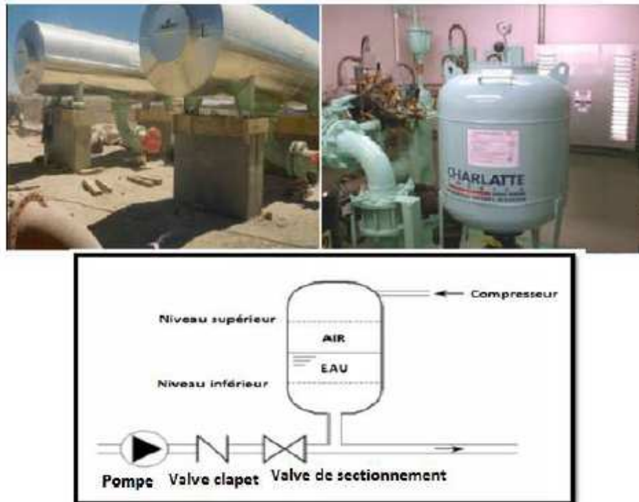
Figure 8.10 : principe de fonctionnement d'un réservoir d'air
