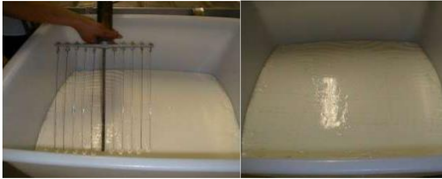
Figure 6: découpage du caillé gélifié (Farkye, 1999)
