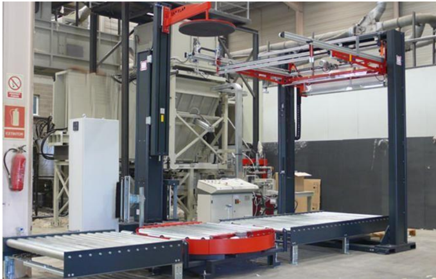
Figure II.2 : Banderoleuse de palettes automatique à plateau tournant modèle TRM500.
