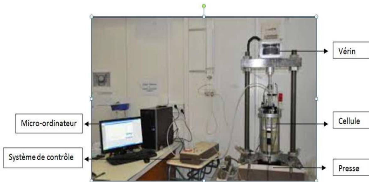
Figure II.4: Dispositif de l'essai triaxial cyclique.
