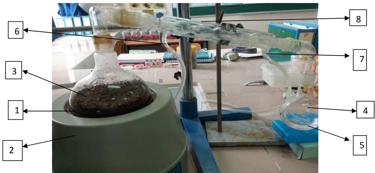
Figure 14 : Montage d'un hydrodistillateur (Biologie, Juin 2019)
