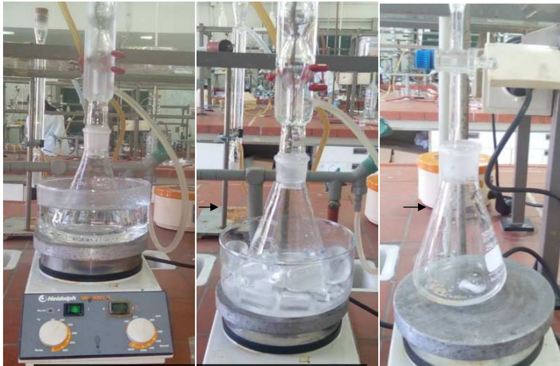
Figure17 : Montage et titrage d'indice d'ester(laboratoire de chimie, Juin 2019).
