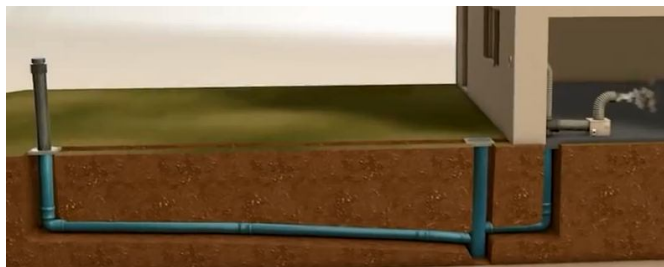
-Figure : image illustrative des composantes d'un puits canadien.
