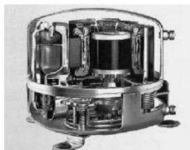
Figure 3.10. Compresseurs à pistons hermétiques
