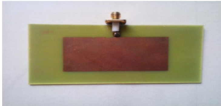
Figure 67 : patch réalisé dans le laboratoire
