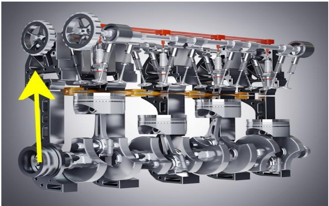
Figure I.14 : représente l'emplacement des organes mobile dans un MCI
