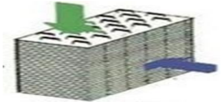
Figure III.10 : Schéma représentatif d'un échangeur à courant croisé.
