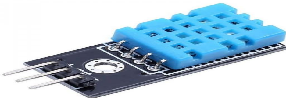
Figure II.18 : Détecteur de température et d'humidité
