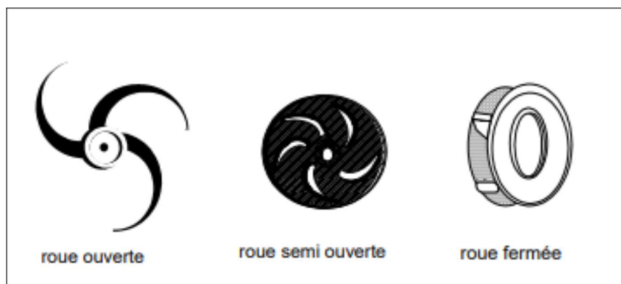
Figure V. 1 : forme de l'aube (roue) des pompes centrifuges
