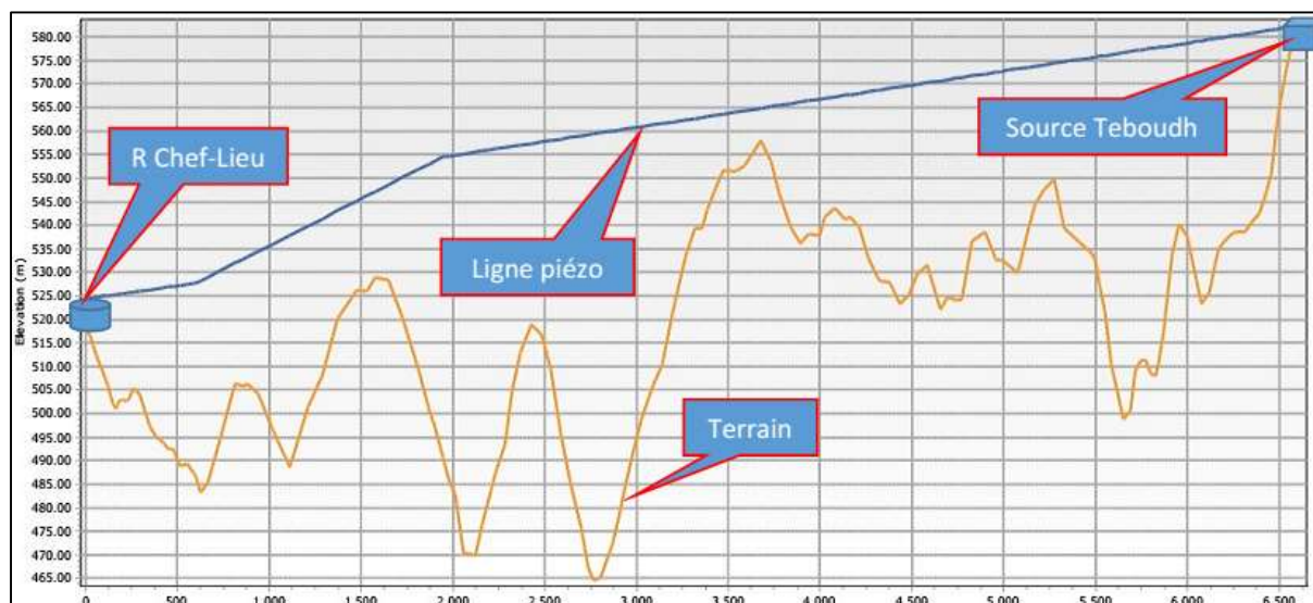
Figure IV.7: Profil Piézométrique de l'adduction Teboudh – Chef-Lieu
