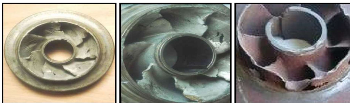
Figure V. 11 : photos illustre le phénomène de cavitation sur les aubes d'une pompe centrifuge.
