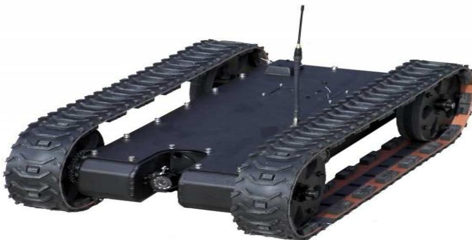
**Figure III.3.** Robot de surveillance à Chenilles
