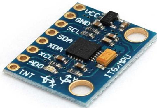
**Figure III.19.** Accéléromètre.
