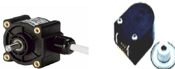
**Figure III.18.** Capteurs proprioceptifs (odomètres).
