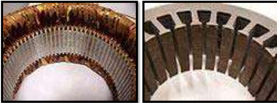
Figures I.2 : Vue du stator d'un moteur asynchrone triphasé à cage d'écureuil avec et sans bobinages
