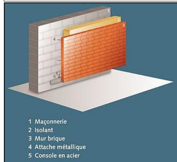
Figure II.5 : Isolation thermique répartie - Source : www.wikinédia.fr
