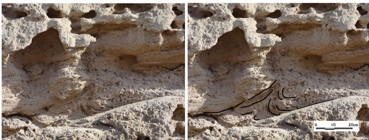
Photo 3 : Déformation plastique des sables fins, observée dans les dépôts de terrasse calabrienne
