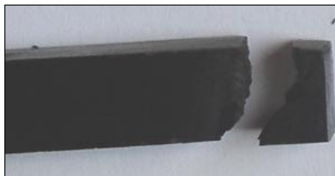
Figure III-22 : Échantillon Ep/8Ca rompu lors du test d'usure à 1Mpa.m/s
