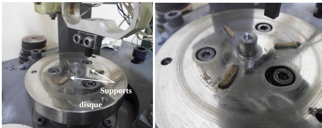
Figure III-6 : Supports disque pour réglage de planéité
