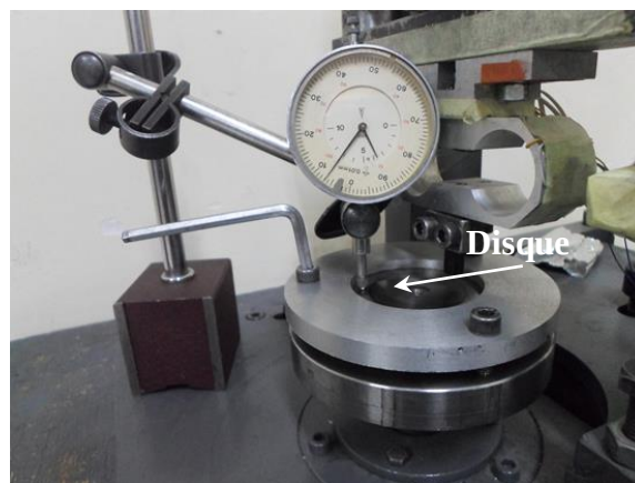
Figure III-7: Réglage de planéité lors du montage du disque
