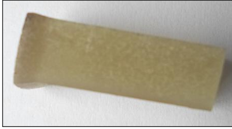
Figure III-26 : Échantillons Ep/22H rompu lors du test d'usure à 1MPa.m/s
