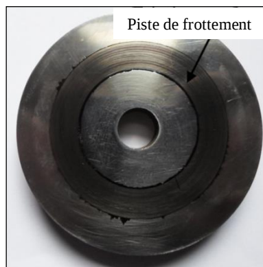
Figure III-31 : Fine couche d'huile sur la surface du contact du disque
