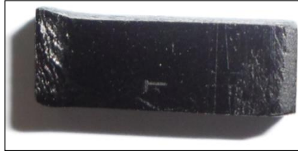
Figure III-38: L'échantillon Ep/6Ca/31H déformé lors du test d'usure à 3Mpa.m/s
