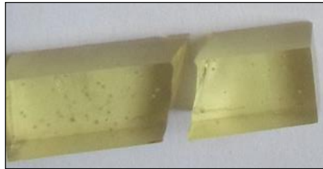
Figure III-20 : Échantillon Ep rompu lors des tests d'usure à 1Mpa.m/s
