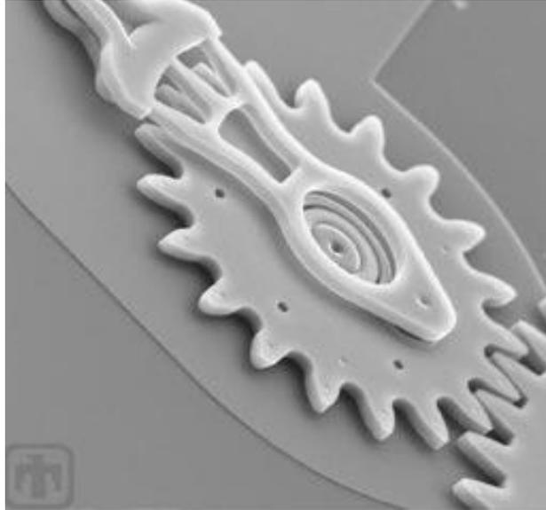
a- Figure d'un MEMS constitué d'un système d'engrenage micrométrique.
