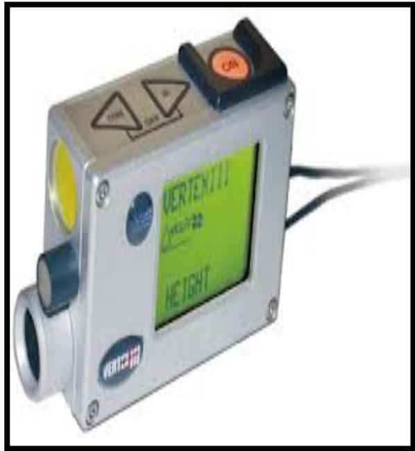
Figure 23 : dendromètre
