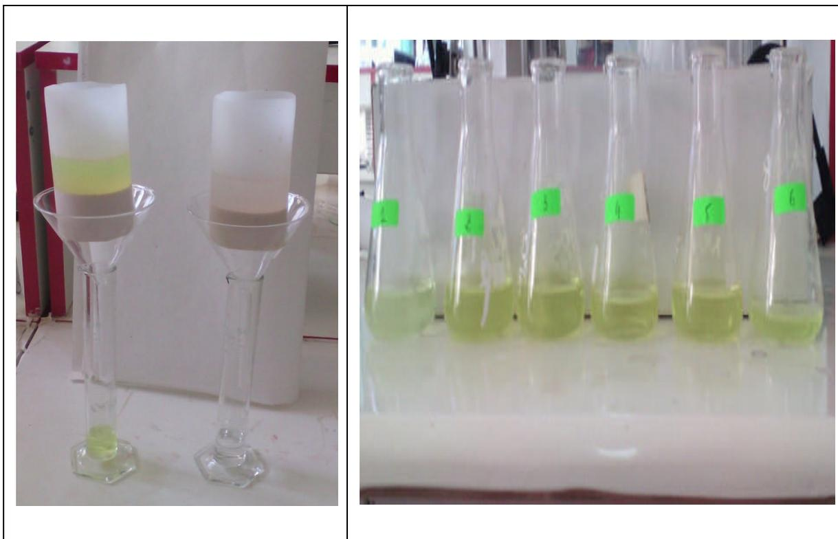
**Figure IV.7 :** Dispositif utilisé lors de rétention chimiques : ici plâtre seul et solution de paranitroaniline
