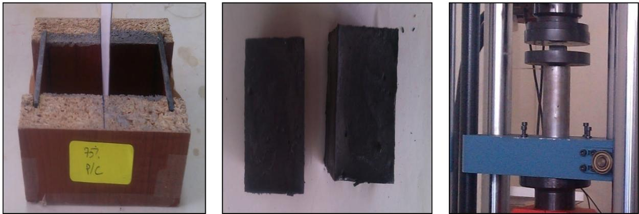
**Figure III.14** : photos de différentes étapes de préparation des cubes du charbon
