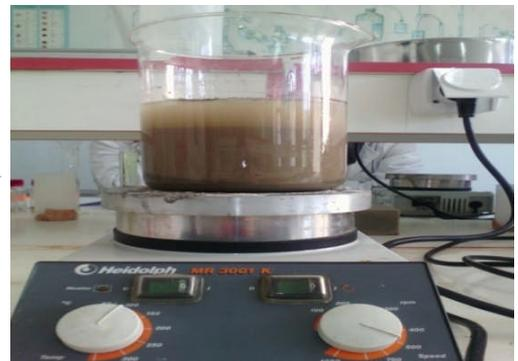
**Figure III.4 :** Agitation du mélange eau/sol avant traitement par les ultrasons
