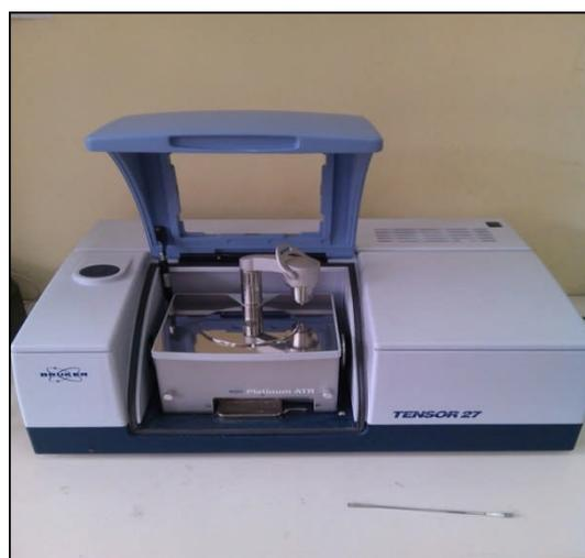
**Figure A.6.1** : Spectromètre infrarouge FTIR utilisé.
