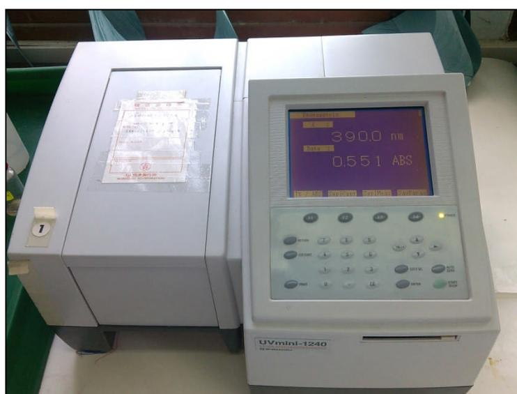
**Figure A.7:** Spectrophotomètre UV/visible utilisé.
