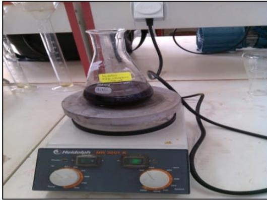
**Figure III.11** : Diapositive de procédé d'adsorption charbon +4-nitroaniline au début d'agitation
