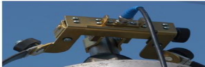
Fig .II.23 Raccordement de la pince pour borne de traversée au câble coaxial bleu
