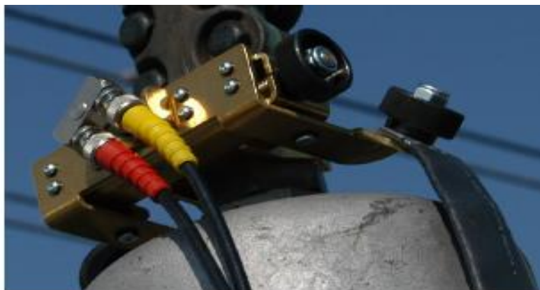
Fig. II.21 Raccordement de la pince pour borne de traversée aux câbles coaxiaux jaune et rouge
