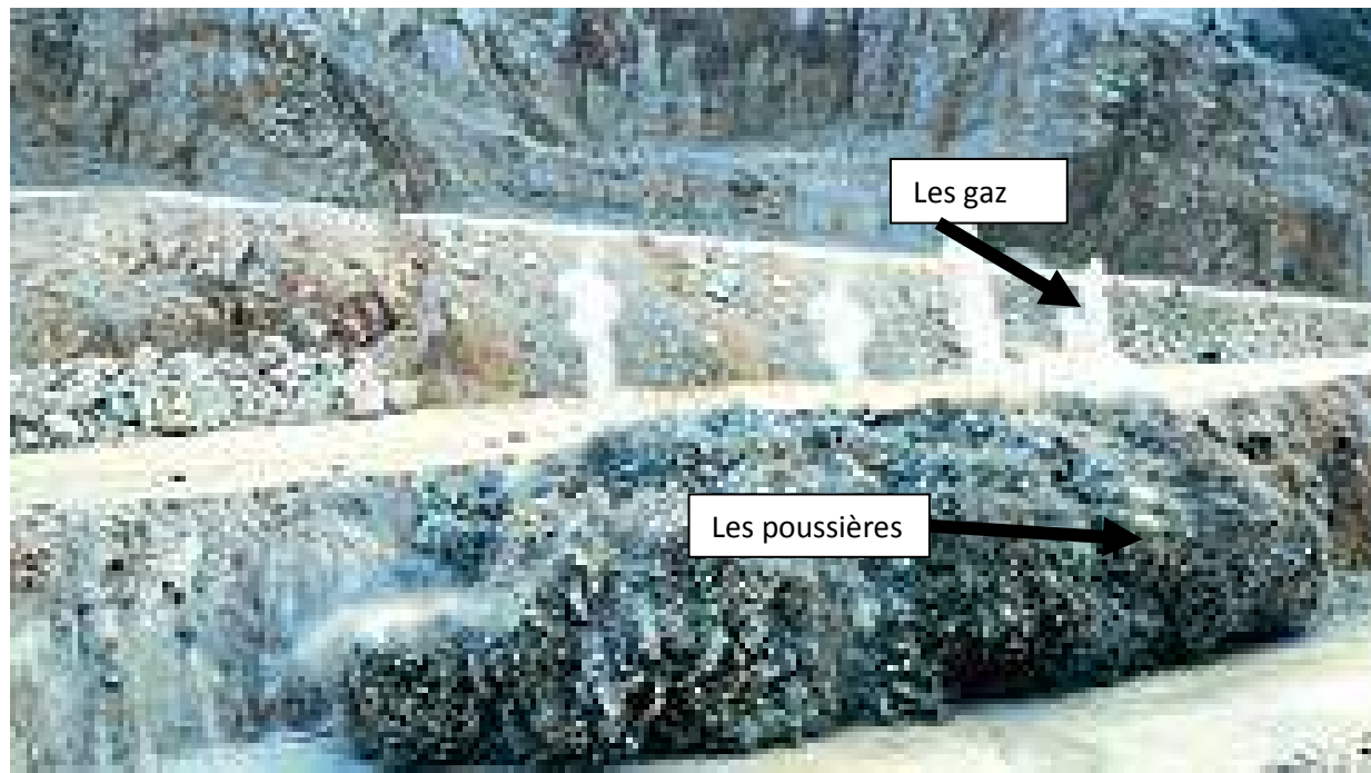
Figure 5 : Les polluants atmosphériques lors de tir de mine. [17]
