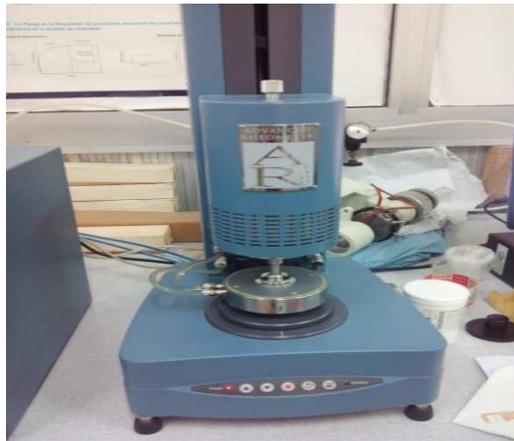
**Figure12:** Rhéomètre AR 2000
