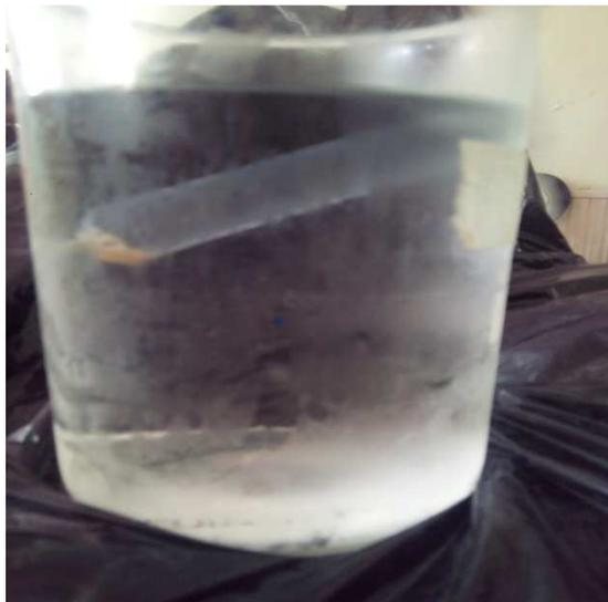
**Figure 9** : purification d'extrait de jujube dans le sac de dialyse
