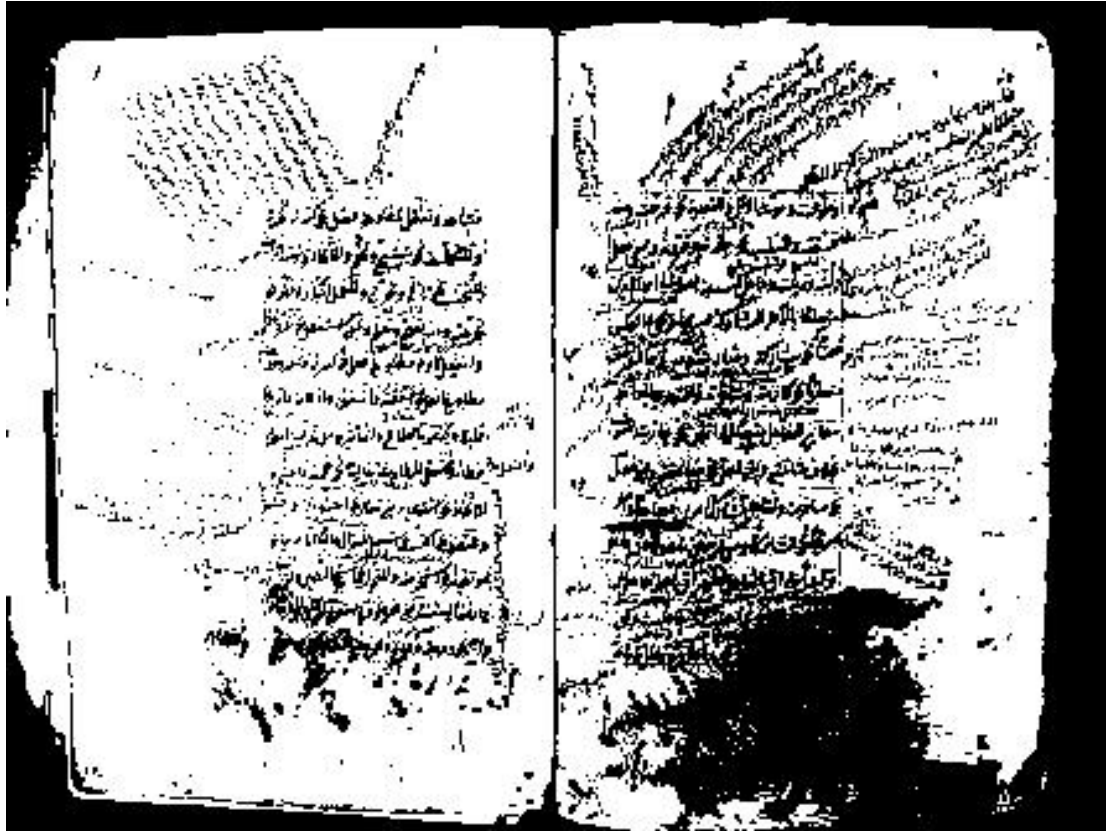
Fig.3.2.12. Manuscrit3 : image binarisée avec la méthode du seuil fixe T=110 [20]
