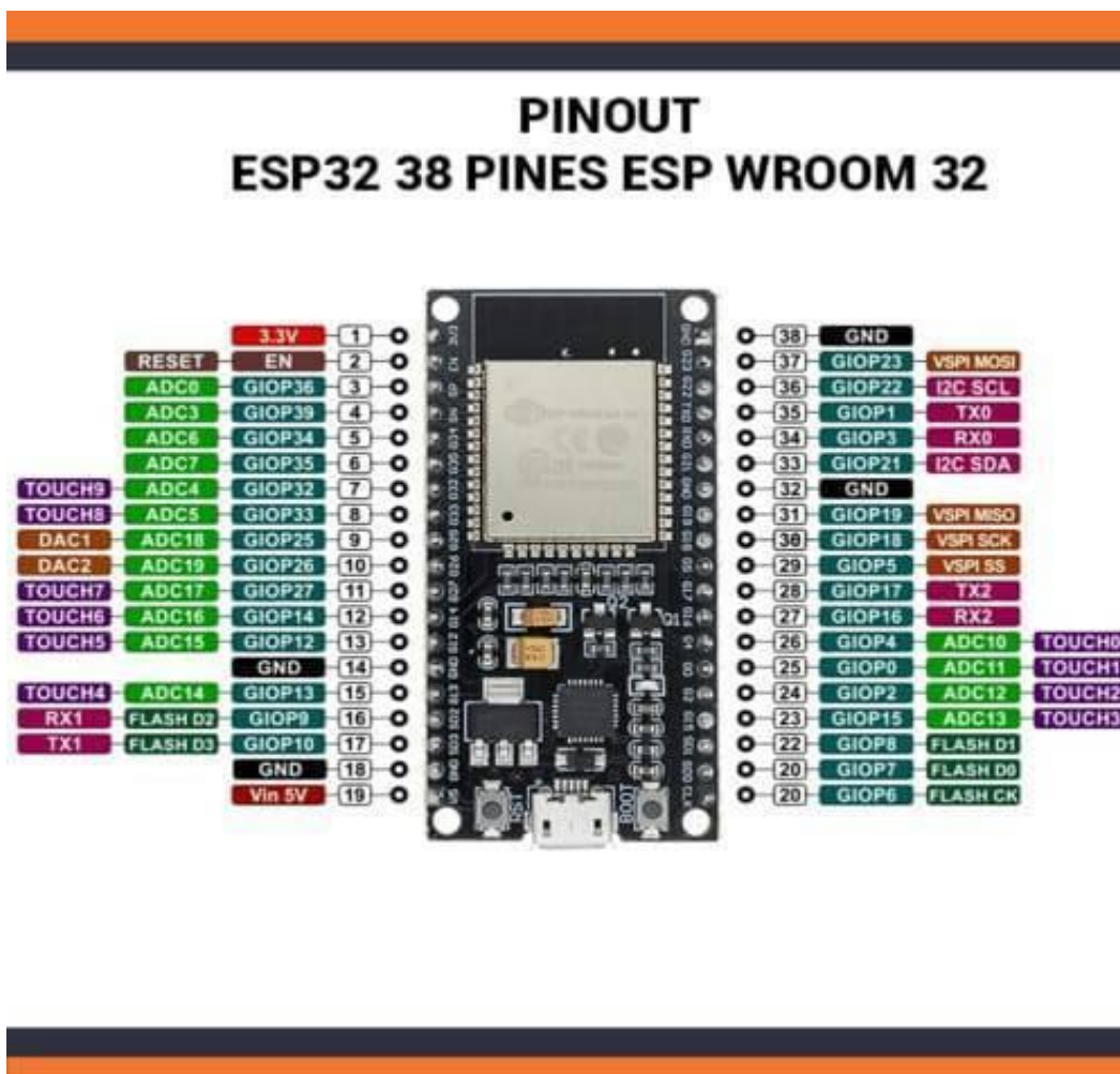
Figure II.12 Repérage des broches des modules ESP 32 [36].
