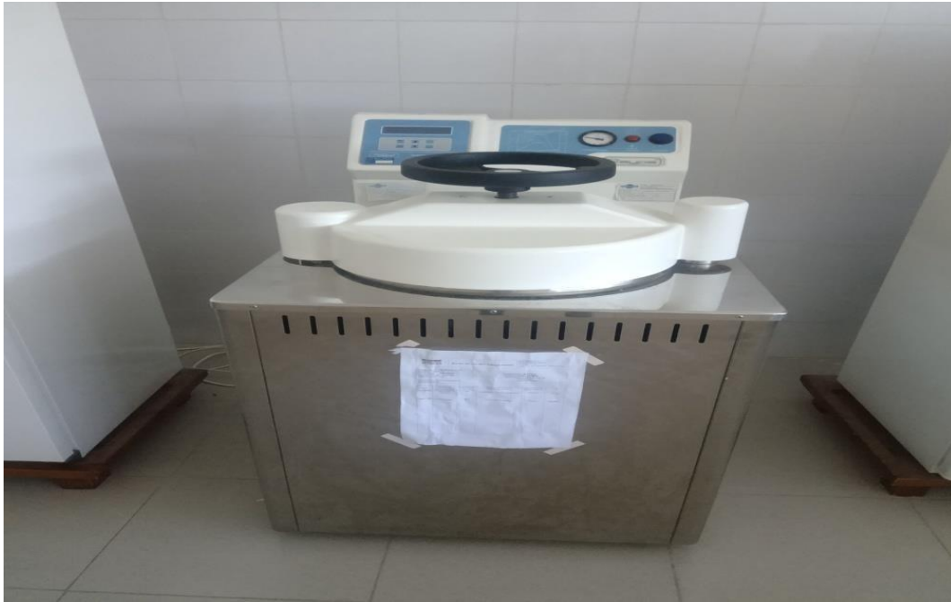
Figure n°13 : Photo del'autoclave utilisé pour la stérilisation des flacons bactériologique.
