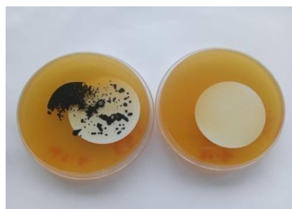
Dénombrement des ASR dans l'eau brute et traitée d'IMSOUHAL du 21/06/2022
