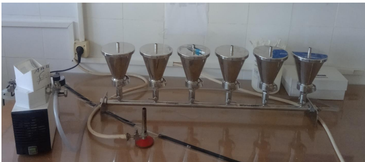
Figure n°24: figure représente la membrane de filtration en bactériologie.
