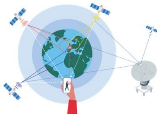
Figure I.3 Principe de positionnement par satellites [20].
