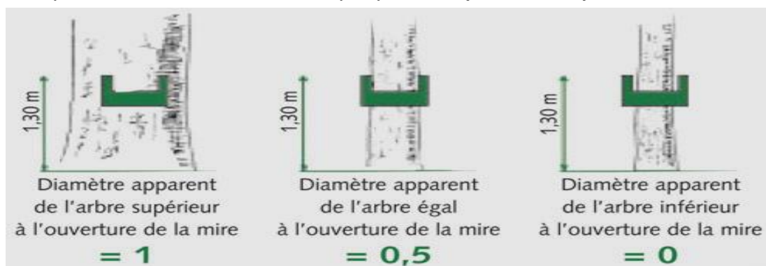
Figure 35 : MESURE DE LA SURFACE TERRIERE D'UN PEUPELEMENT AVEC LE RELASCOPE A CHAINETTE
