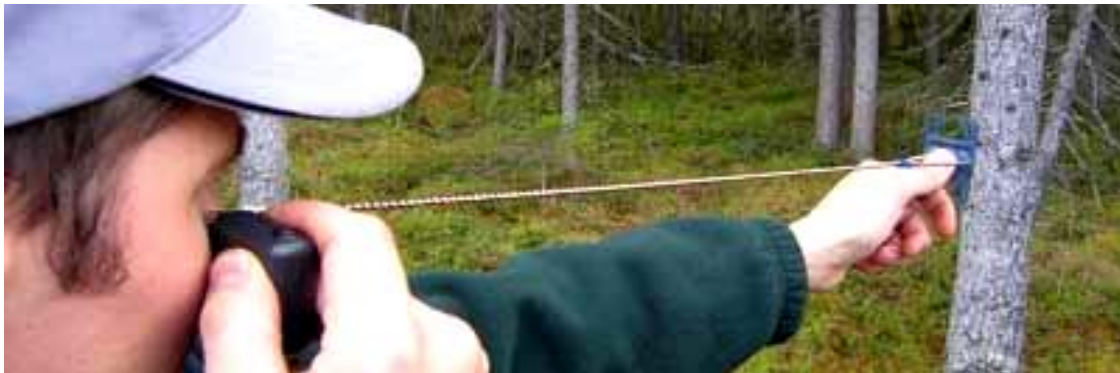
Figure 34 : LA VISEE AVEC LE RELASCOPE A CHAINETTE
