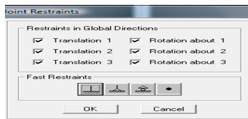
fig V.36 : encastrement des appuis
