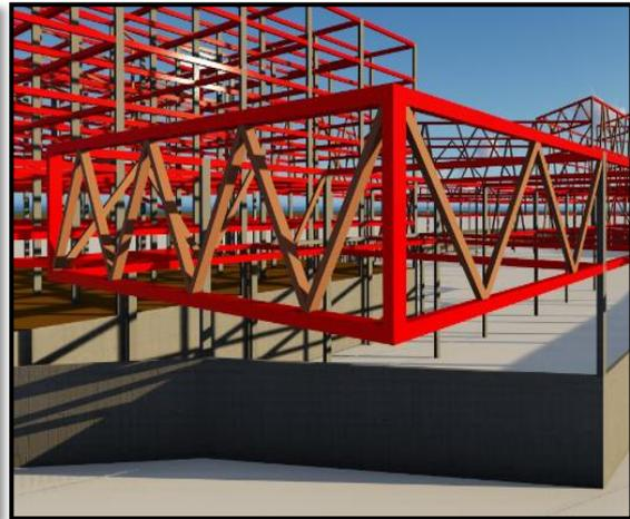
Figure 111: contreventement de l'élément en porte à faux sur l'entrée secondaire vers les ateliers/ source : auteurs.
