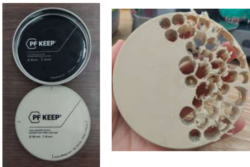
Figure. 12 : présentation d'un bloc de PEEK neuf et d'un autre déjà utilisé pour la confection des inlay-cores
