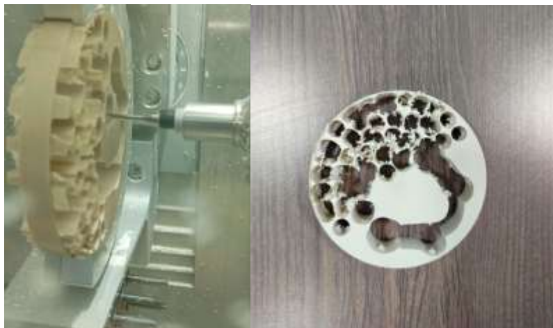
Figure. 48 : usinage de l'inlay core a partir d'un bloc industriel du PEEK.
