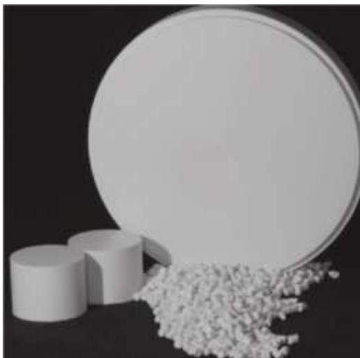
Figure 44: PEEK sous forme de granulés ou de disques usinables par CFAO (Stawarczyk et al, 2015) [65].
