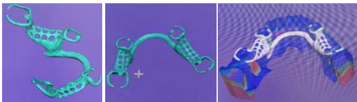
Figure. 11: insertion du châssis final sur le modèle numérique initial (avant suppression de contre-dépouilles).
