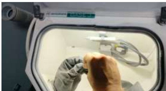
Figure. 76: sablage à l'aluminium.
