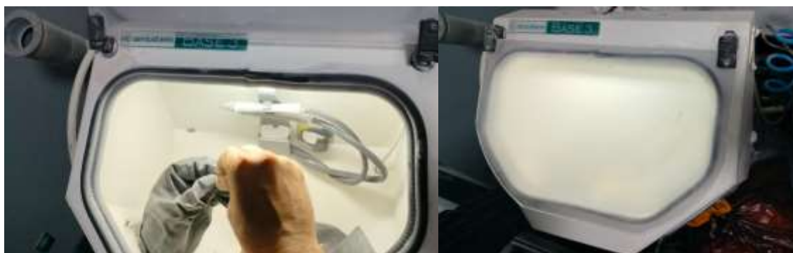
Figure. 53 :sablage à l'aluminium.
