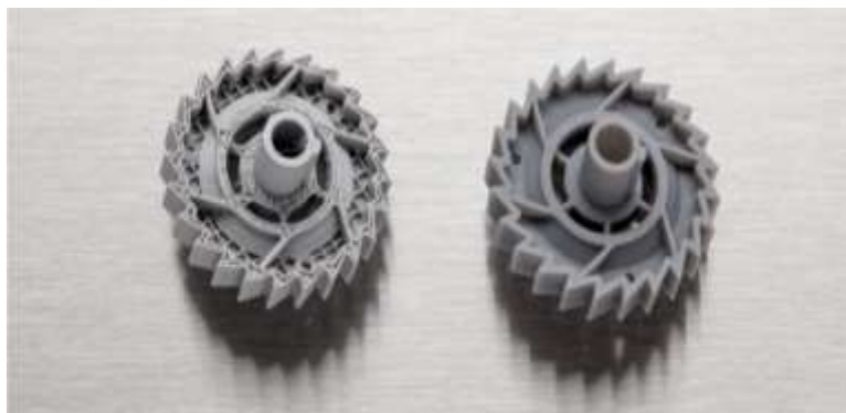
Figure 50: Pièce fabriquée par FDM (à gauche) comparée à une pièce fabriquée par SLA (droite). [50].
