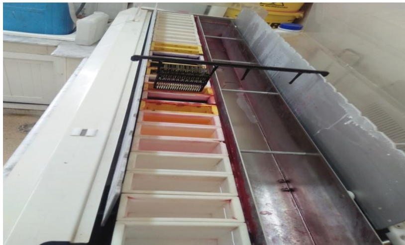
Figure 19 : Dispositif Leica de réhydratation et coloration (Originale, 2021).
