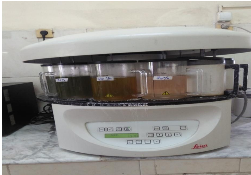
Figure 15 : Appareil circulaire de déshydratation et imprégnation Leica (Originale, 2021).
