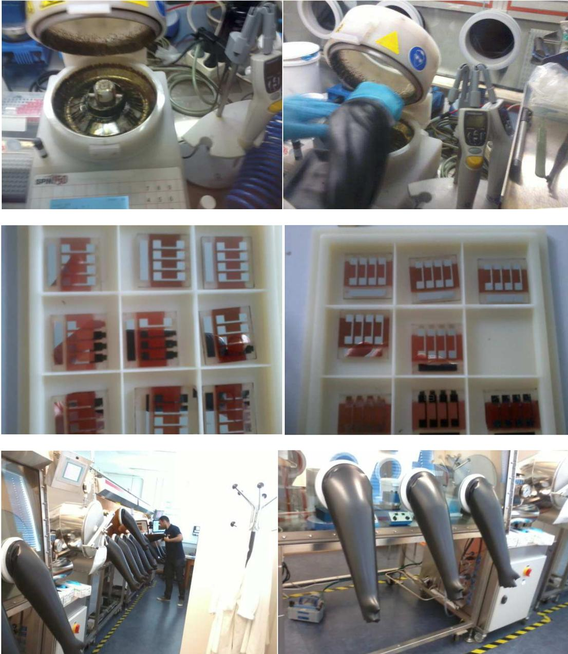
Figure V.13: dépôt de la couche organique dans la boîte-à-gants
