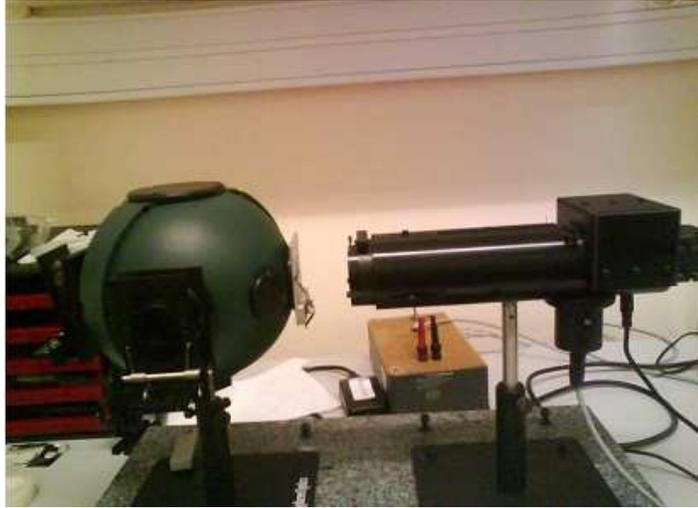
Figure V.18 : spectromètre muni d'une sphère intégrante, utilisé pour nos caractérisations.
