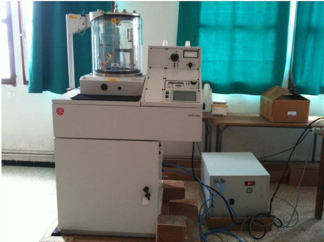
Figure V.4: photographie de l'évaporateur existant au sein de notre Laboratoire ( type AUTO306 HHV).
