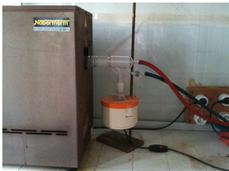
Figure V.1: photographie du système de dépôt par APCVD utilisé.
