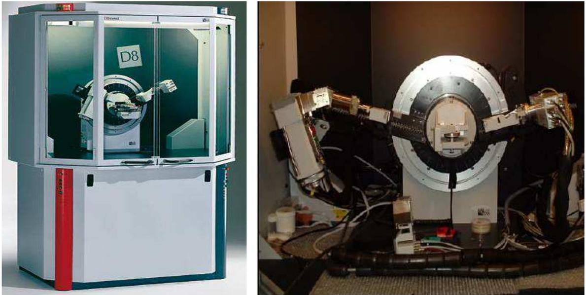
Figure V.31 : photographies (a) du diffractomètre BRUKER AXS D8 ADVANCE et (b) de l'ensemble source, détecteur et porte échantillon.
