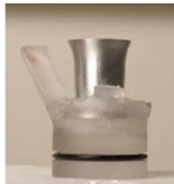
b) Sabot et échantillon projectile déformé.
