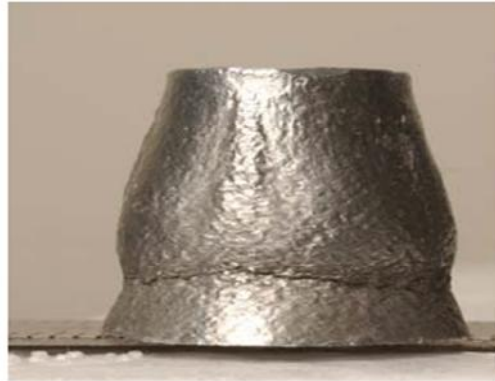
Figure (I-20) : Essai de Taylor direct pour un projectile en aluminium [PAN05].
