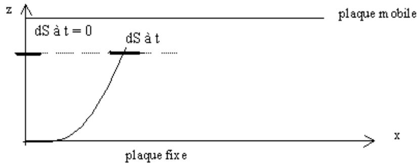
Fig.II.16 déformation en fonction de la distance x ; (déformation de cisaillement)
