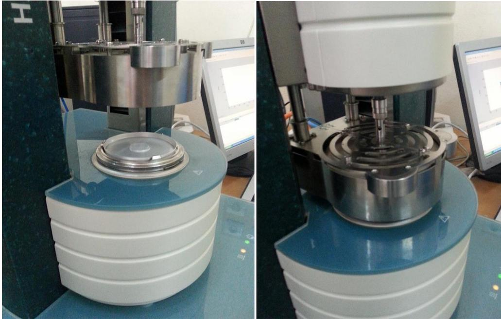
**Fig.III.4. Méthode de mesure d'un rhéomètre**
