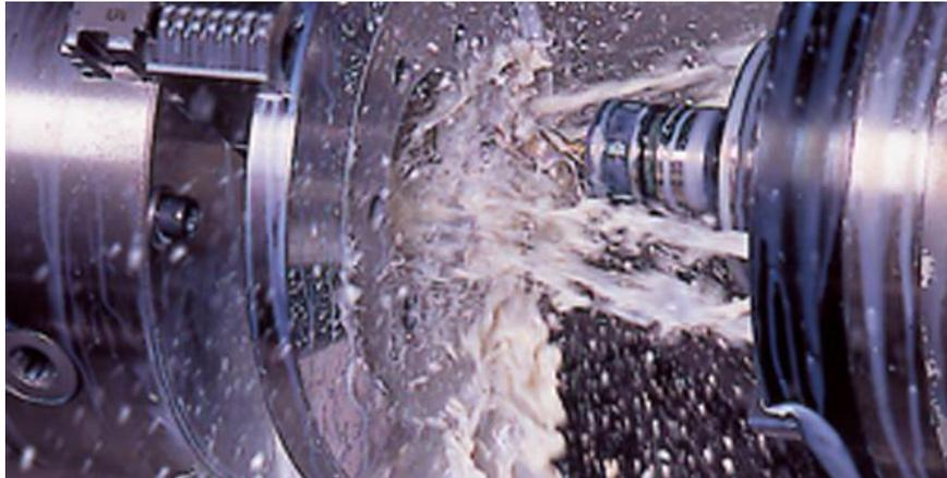
Fig.I.3 fluide de coupe en usinage [2]
