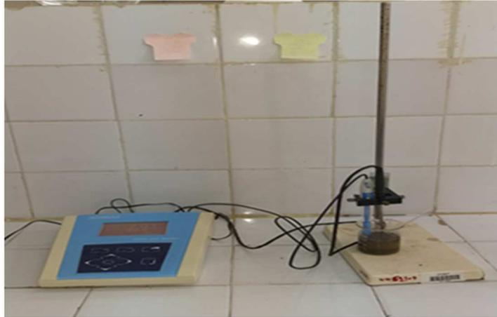
**Figure 14 :** Détermination du pH à l'aide d'un pH-mètre au niveau du laboratoire de pédologie de l'INRF (photo originale, 2021)
