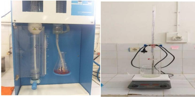
**Figure 17** : Détermination de l'Azote total au laboratoire de pédologie de l'INRF (photo originale, 2021)
