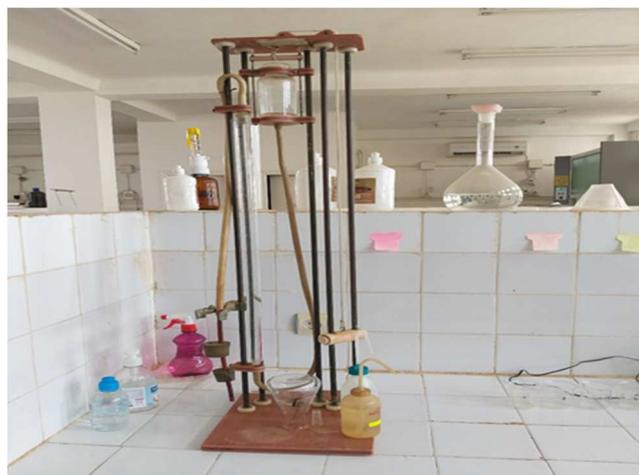
**Figure 18** : Dosage du calcaire total à l'aide d'un calcimètre au laboratoire de pédologie à l'INRF (photo originale, 2021)
