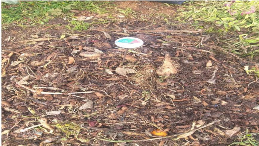
**Figure 20** : Mesure de la température à l'aide d'un Thermo-compost (photo originale, 2021)
