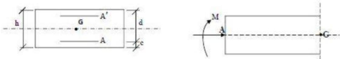
**Figure.III.1.3: Section de l'acrotère soumise à la flexion composée.**
