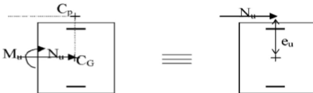
**Figure.III.1.4: position du centre de pression.**
