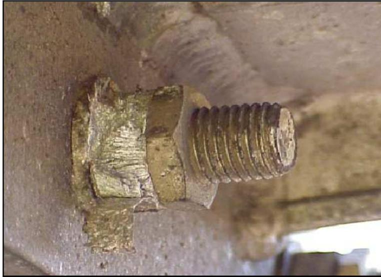
**Figure I.3** : Exemple de corrosion galvanisée
