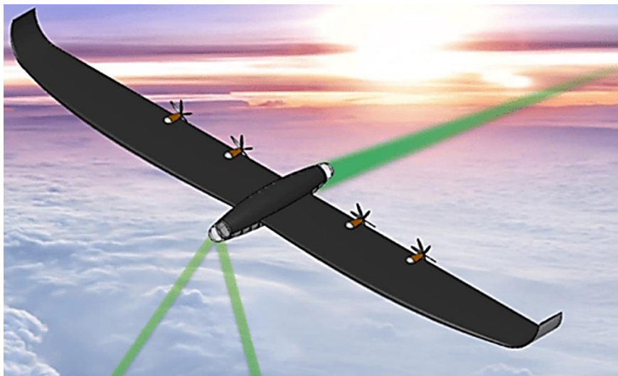
Figure I.12 : Transmission d'énergie sans fil à partir d'avion laser étudié par la DARPA [15].
