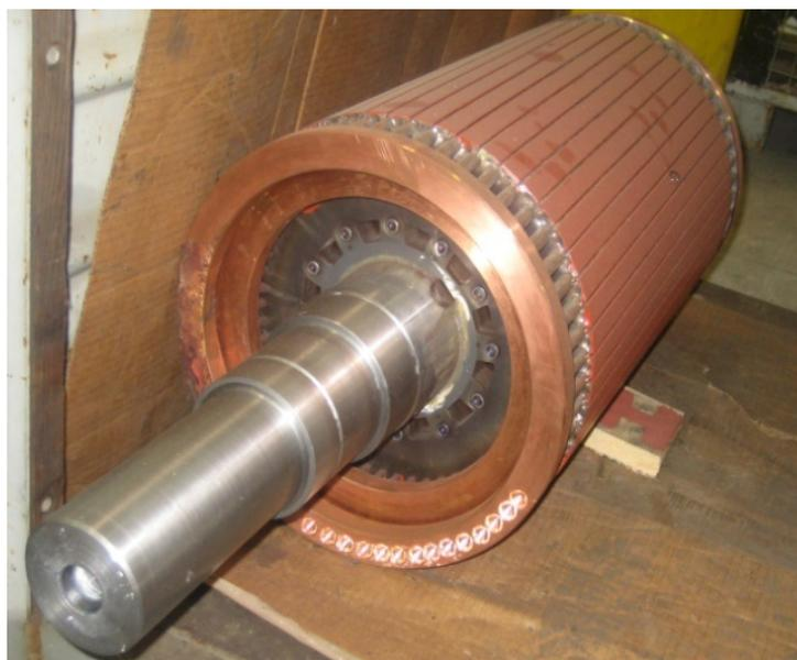
Fig. II-5. Rotor à double cage.
