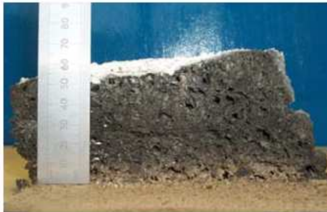
c) Vue en coupe du char ainsi formé après l'essai
