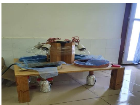
Figure 31 : Appareil de Berlèse
