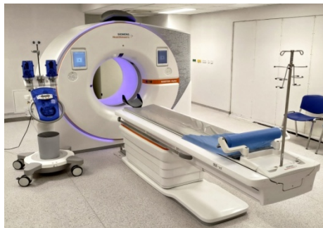
Figure 66 : Système de Tomodensitométrie Multi coupe Siemens en Environnement Hospitalier
