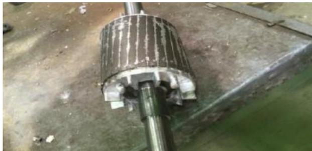
Figure III.2 : rotor à cage d'écureuil en aluminium.
