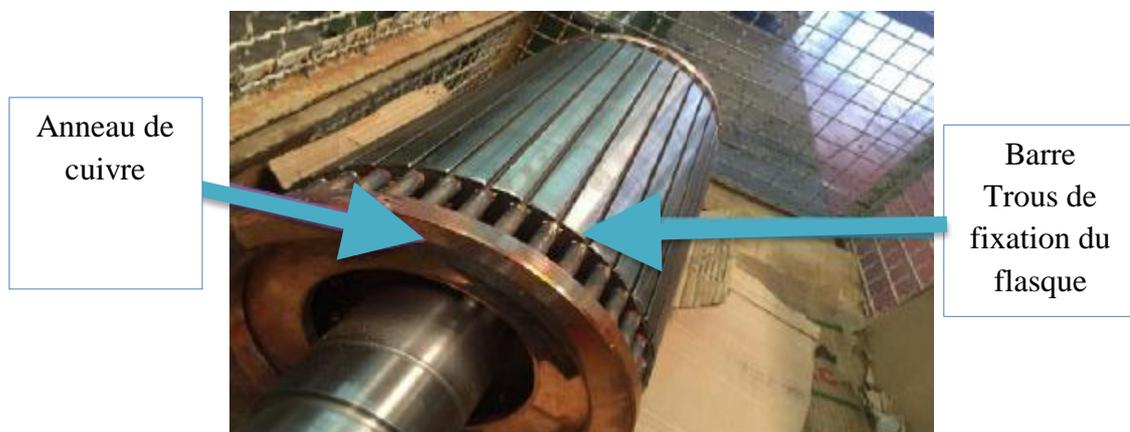
**Figure III.6:** Rotor à cage d'écureuil en cuivre.
