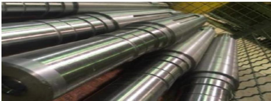
**Figure III.14:** Arbre clavette moteur.
