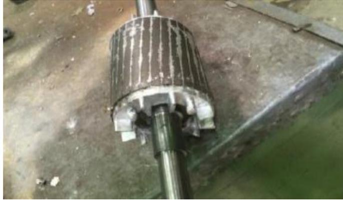
**Figure III.7:** Rotor après injection d'aluminium.
