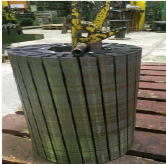
**Figure III.5:** Paquet rotorique riveté.
