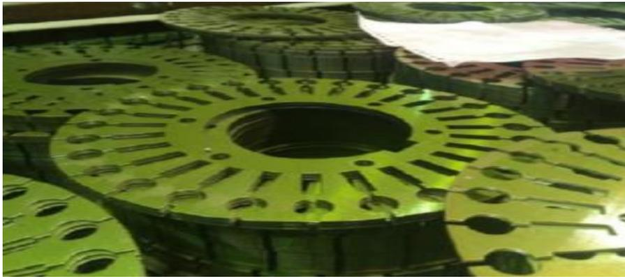
**Figure III.3 :** Tôles rotorique
