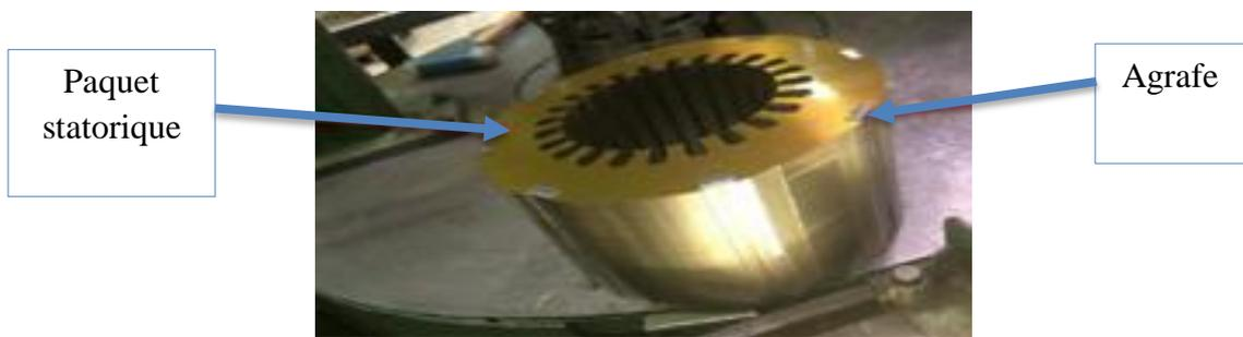
Figure III.1 : Paquet statorique.
