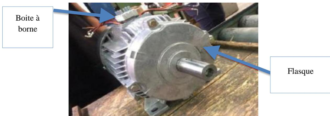
**Figure III.24** : Moteur semi-fini.
