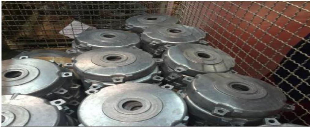
**Figure III.15 :** Carcasse en alliage d'aluminium.
