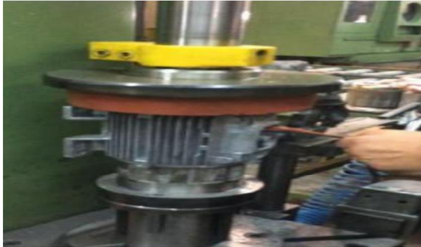
**Figure III.22 :** Presse de pré-montage.
