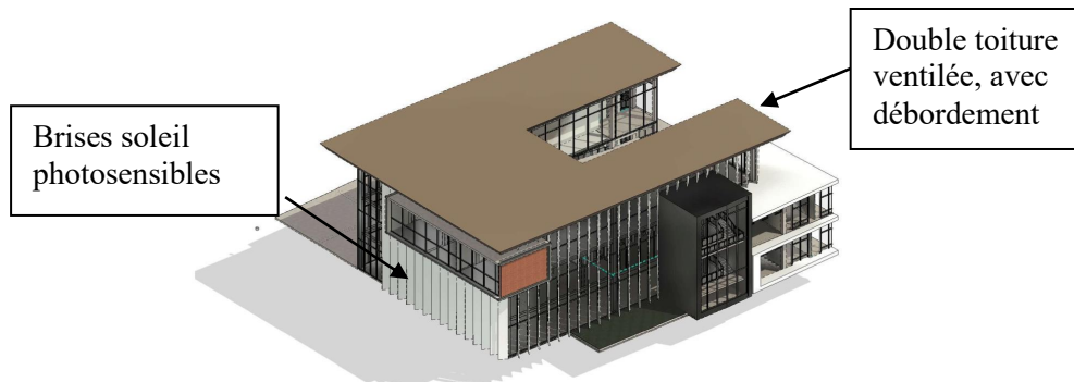
Figure 77 : Dispositifs de protections solaires. Source : Auteurs.
