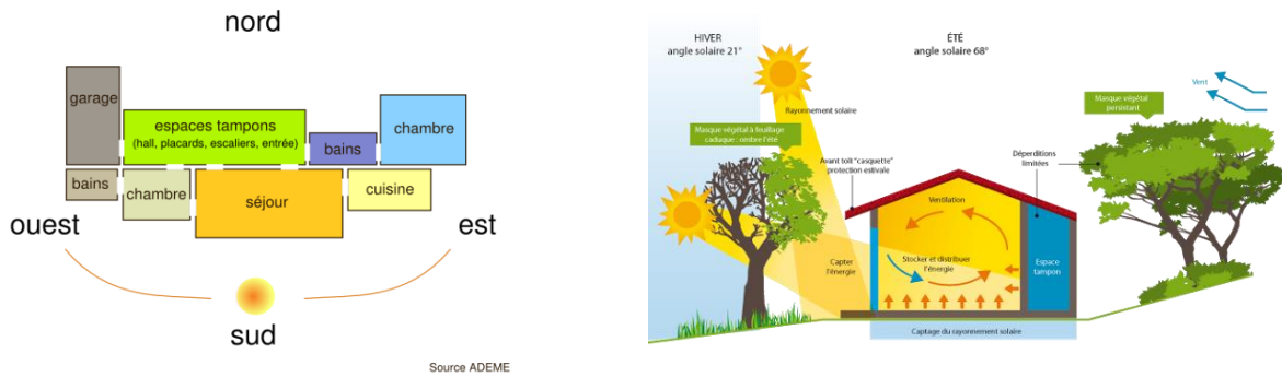
Figure 29 : Les principes de base d'une conception bioclimatique. Source : https://www.e-rt2012.fr/Les principes de base d'une conception bioclimatique
