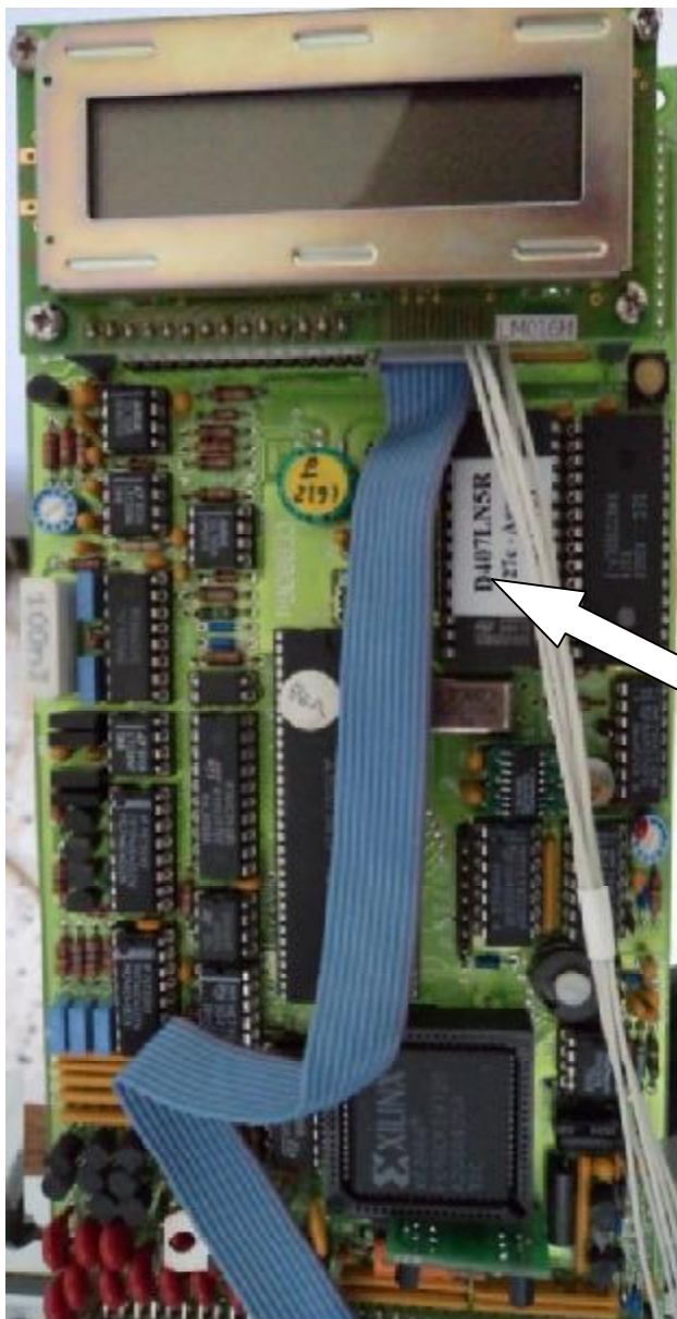
Fig.4.2 : remplacement du circuit mémoire
