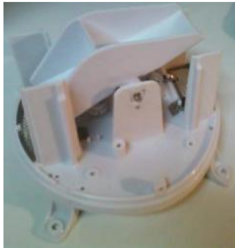
Fig.2.7 : pluviomètre à augets basculeur
