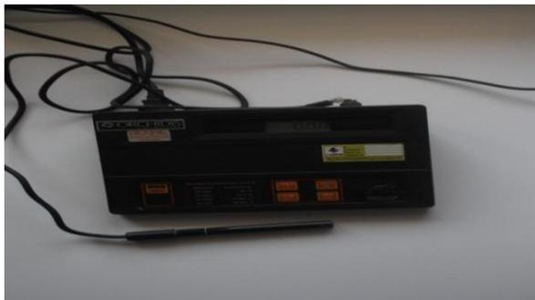
**Figure IV.3 :** Conductimètre
