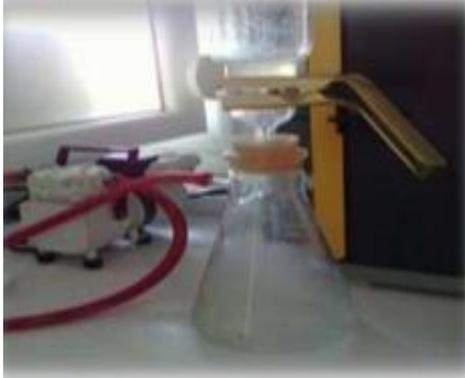
**Figure IV.4** : Dispositif de filtration sous vide
