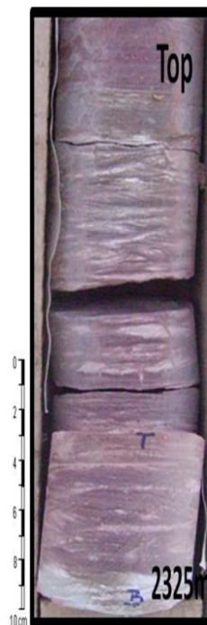
Figure II.26: Echantillon de carotte montrant des traces d'un paléosol (plein d'inondation) dans le TAGI dans le puits RN-103.
