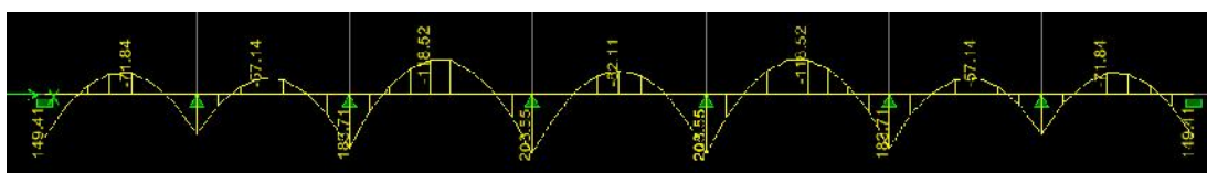
Figure XI.8 diagramme des moments fléchissant(ELS)
