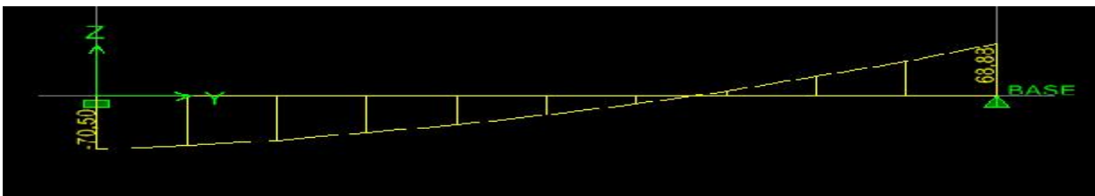
Diagramme des efforts tranchants du mur plaque à l'ELS
